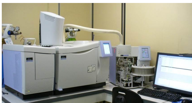
Figure 2: Photography of Thermal desorption System coupled to GC/MS/FID Photographie du système de Thermodésorption couplé au GC/MS/FID
