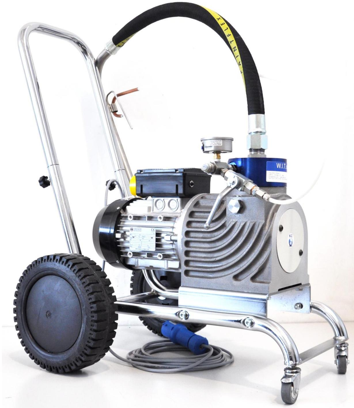
**W.I.T. GOLD 6500 NEW** apparecchiatura airless elettrica a membrana per spruzzatura AEROGEL PAINT
