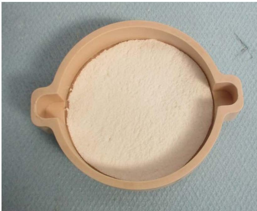
Figura 4. Attrezzatura di prova + campione di rasante termico.
